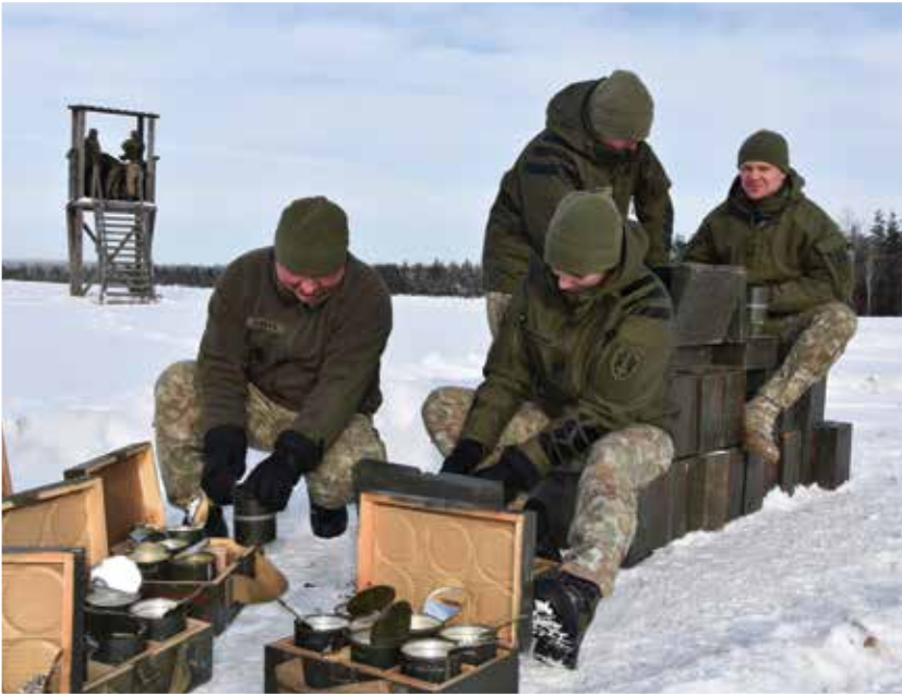
Ginkluotės depo šaudmenų ir sprogmenų ekspertai išbandė pirotechnikos dūminį užtaisą Rokfackla 4 . Testavimo metu buvo stebimas dūminio užtaiso sprogdiklio suveikimas ir degimo laikas.
