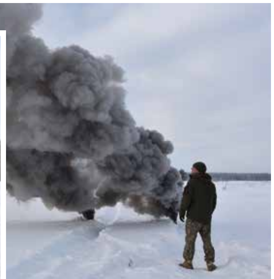
Ginkluotės depo šaudmenų ir sprogmenų ekspertai išbandė pirotechnikos dūminį užtaisą Rokfackla 4 . Testavimo metu buvo stebimas dūminio užtaiso sprogdiklio suveikimas ir degimo laikas.
